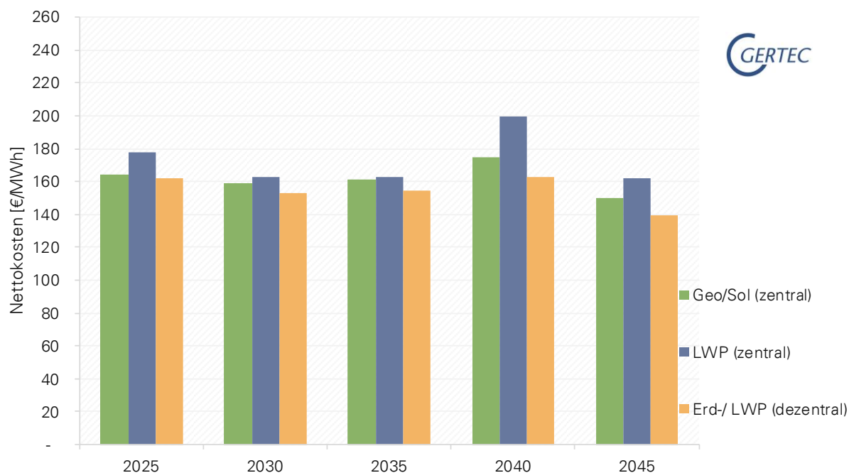
Abbildung 91 Wärmegestehungskosten im Vergleich (FG2 Z2)
